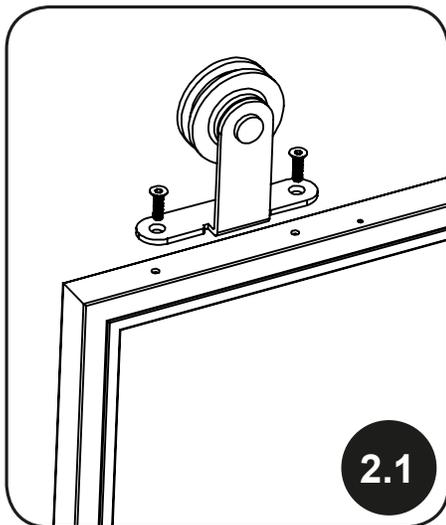
Aligner les roulettes et les vis avec les trous filetés.
