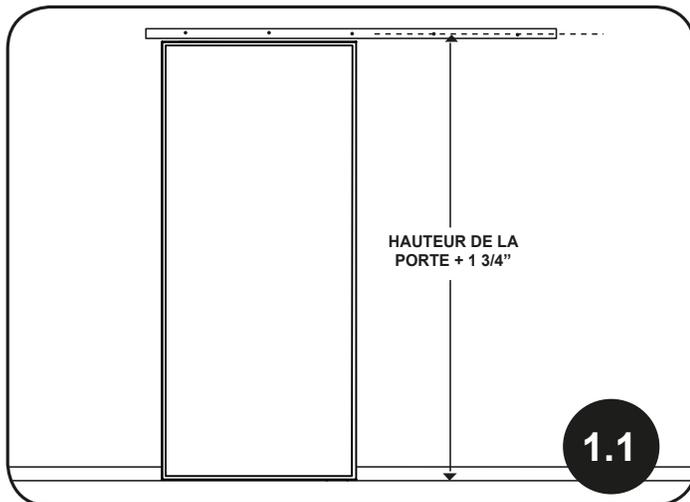
À partir du sol, ajouter 1 3/4" à la hauteur de la porte à installer pour déterminer la hauteur centrale du rail.
