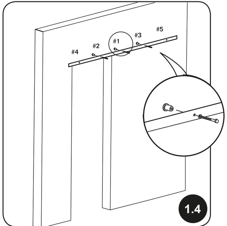
Placer un espaceur derrière le trou #1 et y insérer un tire-fond. Ne pas serrer complètement. Répéter le processus pour les trous #2 et #3. Utiliser un niveau au-dessus du rail pour s'assurer qu'il est de niveau, puis serrer complètement les 3 tire-fonds.
