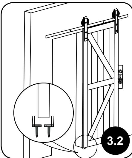
Monter la porte sur le rail, en s'assurant qu'elle est de niveau, puis fixer les guides de porte au sol, le plus près possible de l'ouverture.
