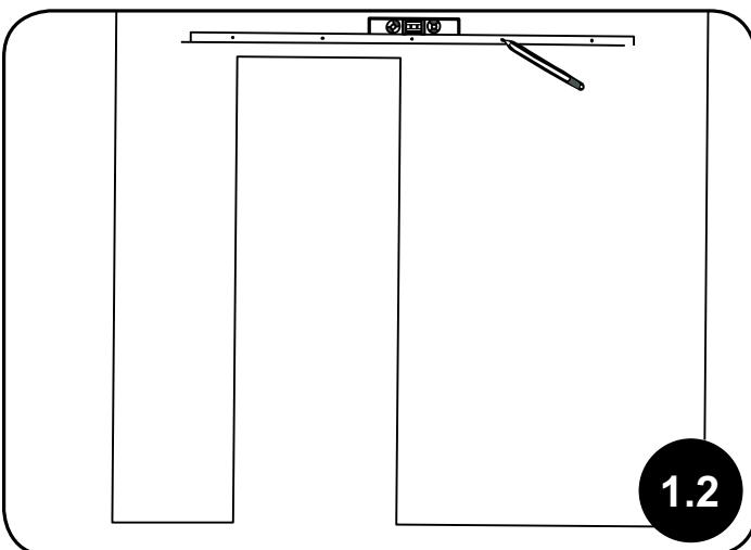
ATTENTION Si le rail n'est pas installé de niveau, la porte risque de s'ouvrir ou de se fermer sans avertissement.
