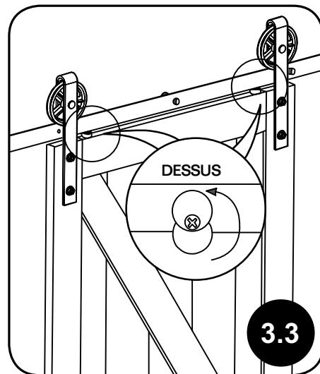
tourner les rondelles anti-déraillement de façon à les positionner au-dessus de la porte et sous le rail. Serrer les vis.
