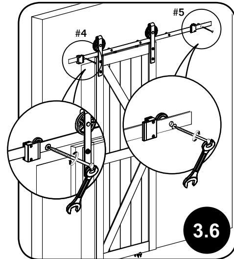
À chaque extrémité du rail, placer les 2 derniers espaces derrière les trous #4 et #5 et y insérer les tire-fonds. Serrez complètement.
