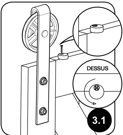
NOTE Les rondelles anti-déraillement doivent être installées pour empêcher la porte de dérailler.
