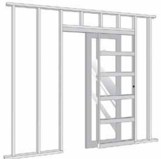
**J. FIXEZ LES GUIDES DE PORTE** AU BAS DES MONTANTS DE SÉPARATION, pour que la porte soit centrée dans l'ouverture.
