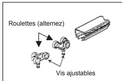
**I. SOULEVER LA PORTE ET POUSSER LES LOQUETS** dans les vis ajustables. Au besoin, à l'aide de la clé fournie, ajustez les loquets pour mettre la porte de niveau.
